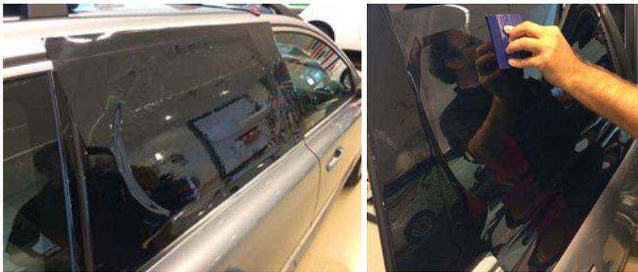
Pour la prochaine étape, rétractez le film à la forme de la vitre, en le chauffant avec un pistolet thermique.
