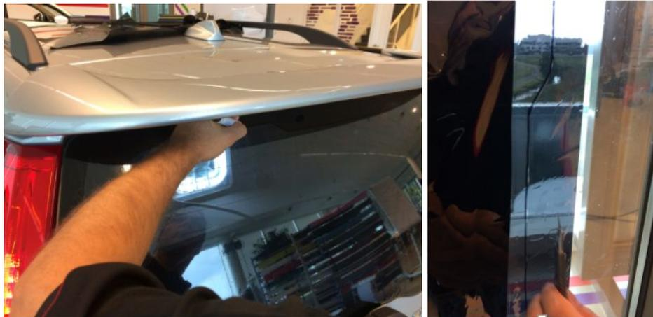
Ensuite, préparez l'intérieur de la vitre arrière en la nettoyant et en l'humidifiant avec une solution d'eau et de savon pour permettre le positionnement du film. Lorsque vous humidifiez la vitre intérieure, assurez-vous de protéger l'intérieur de la voiture.
