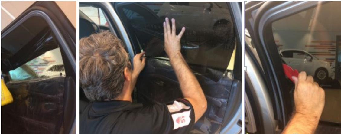
Lorsque le film est en position, humidifiez à nouveau la surface du film et appliquez une pression uniforme avec la raclette pour activer l'adhésif et fixer le film, en enlevant tout l'excès d'eau du côté adhésif.
