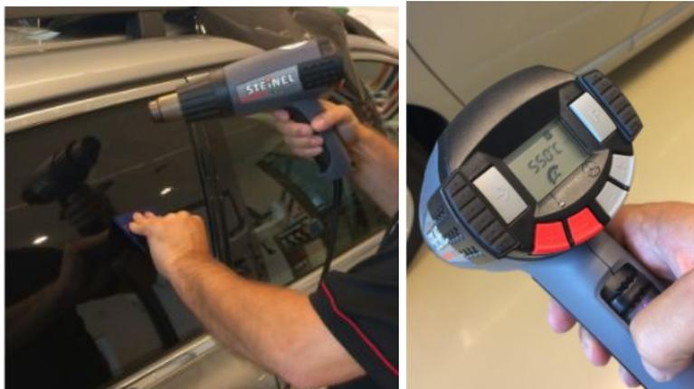
Lors de la chauffe, de petits tunnels/canaux apparaîtront sur la surface. Utilisez la raclette pour les évacuer doucement du film, en partant du centre vers les bords. Dans le cas où de grands tunnels se sont formés, séparez-les en plus petits tunnels en utilisant la raclette, puis supprimez-les, en suivant la même procédure. Assurez-vous de rétracter toute la surface du film, en supprimant soigneusement tous les tunnels qui se sont formés comme expliqué.
